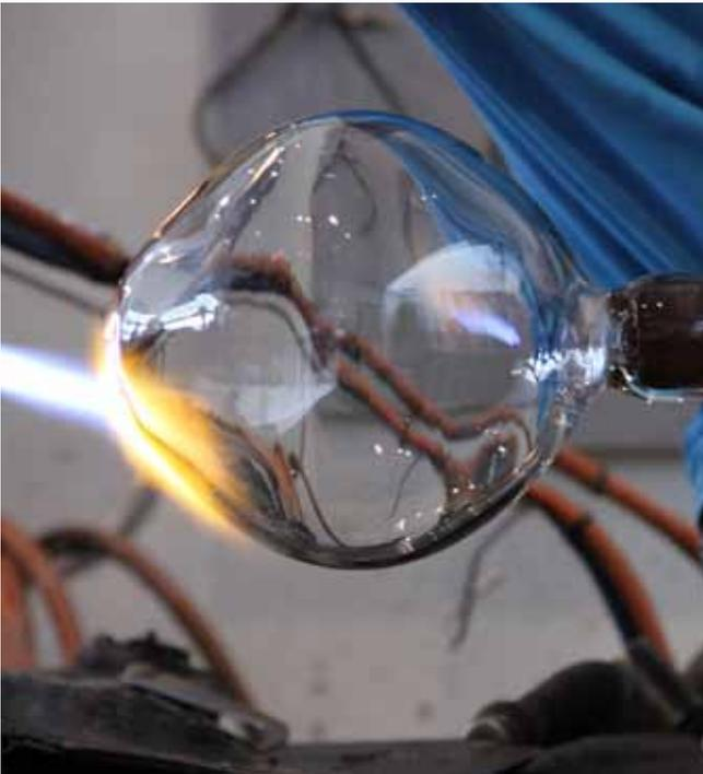
**Façonnage de la sphère à sa sortie du creuset
