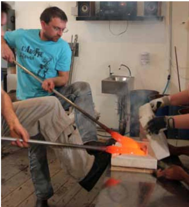
**Tandem Alan-Fabien** soufflage simultané des verriers et mise en place de la matière soufflée dans le moule en plâtre,
